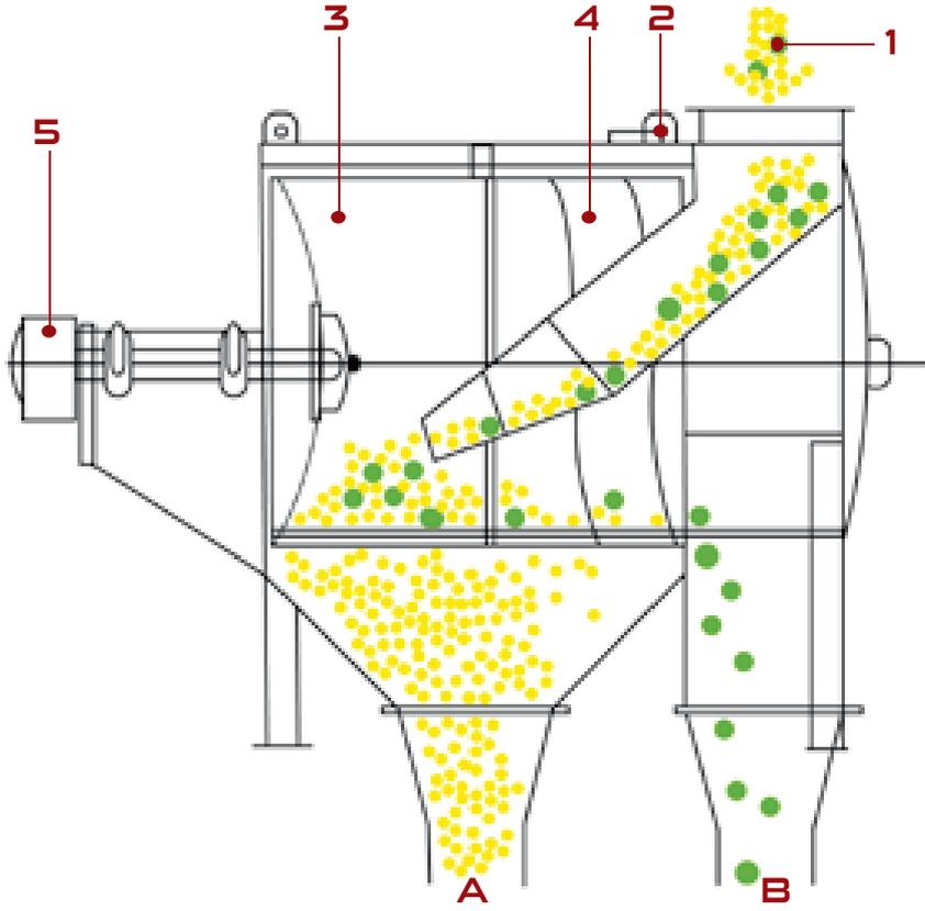
Silindir Gövdeli Elek Makinesinin Çalışma ilkesi
